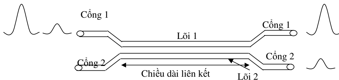
Hình 1. Minh họa sơ lược về sự chuyển mạch phi tuyến trong một sợi quang liên kết. Sự khác nhau giữa các xung ở cổng vào và cổng ra phụ thuộc vào các công suất đỉnh
