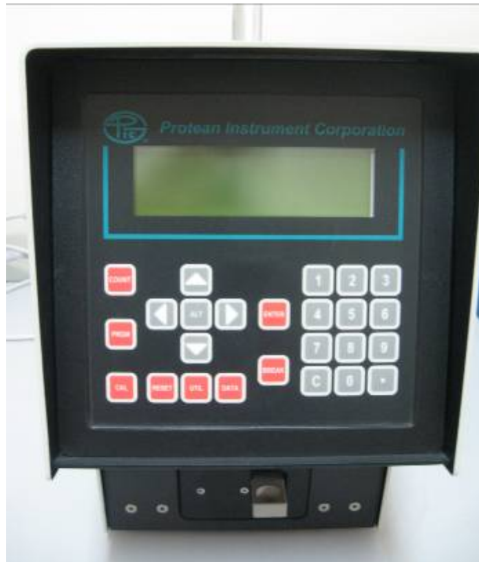
Hình 1: Hệ đo alpha beta phong thấp MPC-2000DP, Mỹ
